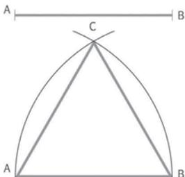
**Construcción de un triángulo isósceles conociendo la base y sus lados iguales**
