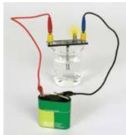
Los ácidos y las bases, en disolución acuosa, conducen la corriente eléctrica.
