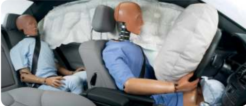
■ Pruebas de seguridad del sistema de airbags
