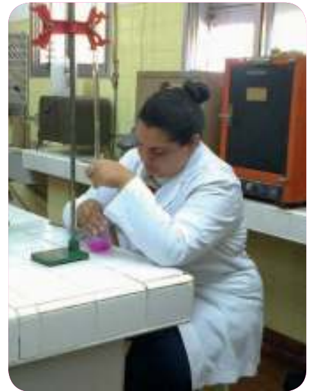
■ Titulación ácido base en laboratorio
