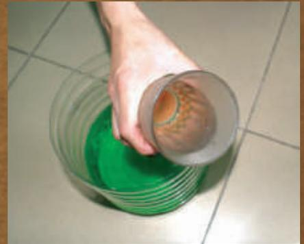
9. **Esperamos** unos dos días y el agua contaminada se evaporará por el calor del Sol. Cuando toque el plástico frío, el agua se condensará y caerá en el vaso lista para ser consumida.
