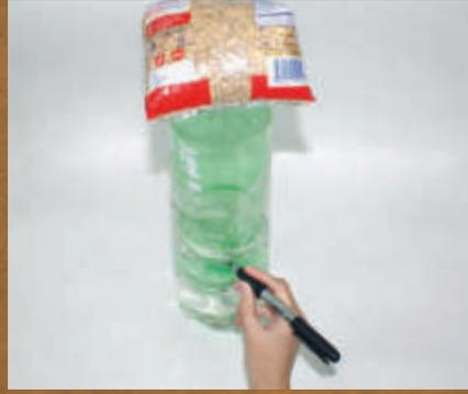
5. Sobre el pico de la botella pequeña, **colocamos** una funda de alimento de 500 g (puede ser funda de sal, azúcar, lenteja, etc.). **Trazamos** una línea marcando el nivel del agua. Esta marca se llama 500 g.
