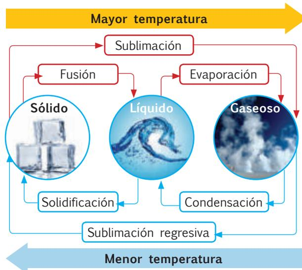
El agua en sus tres estados físicos tiene la misma composición. Sigue siendo agua cuando se presenta como hielo (sólido), como vapor (gaseoso) o como agua fluida (líquido). Sus cambios de estado son producto del aumento o de la disminución de la temperatura.
