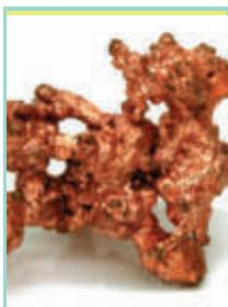
**Cobre:** Es de color rojizo brillante, muy flexible. Sirve para fabricar cables eléctricos.
