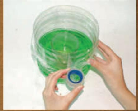
6. **Forramos** completamente el recipiente con el plástico de cocina, dejándolo un poco suelto. Lo **aseguramos** con la cinta adhesiva para que no se escape el calor.
